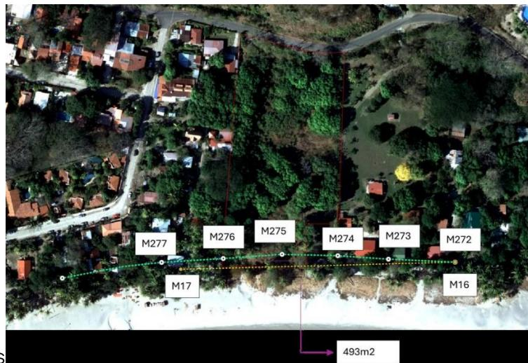
Del montaje anterior se puede concluir lo siguiente: El plano G-0834080-1989 se ajusta con precisión al amojonamiento no oficial M16, M17.
